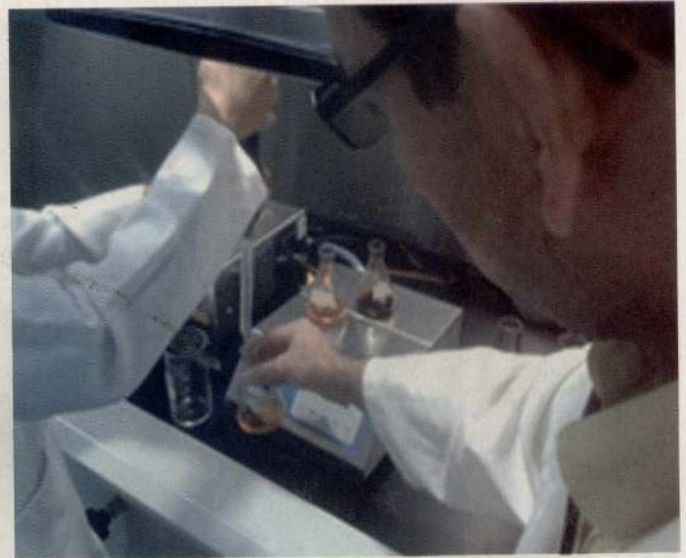
Colocando el ácido sulfúrico concentrado en las muestras de BIOL
